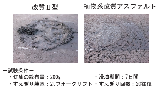
図-11 耐油性試験状況
