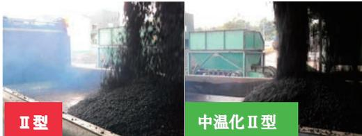
図-3 混合物製造時の煙状況
