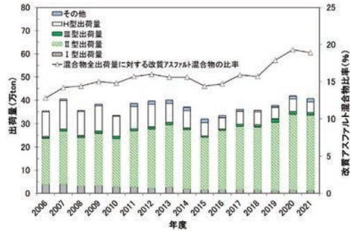
図-1 ポリマー改質アスファルトの出荷量推移
