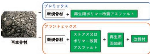
図-4 再生改質アスファルト混合物の製造方法
