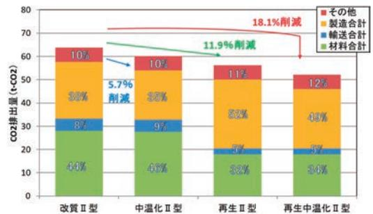
図-5 混合物製造時におけるCO<sub>2</sub>削減量
